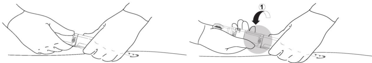
Afbeelding 12. Stap 1 van inwerkingstelling PerQseal® afsluitsysteem (huls verwijderen van het implantaat).
